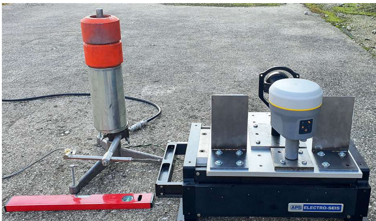
Slika 2: Elektrodinamički pobuđivač s GNSS uređajem i induktivnim osjetilom (vlastita fotografija)
