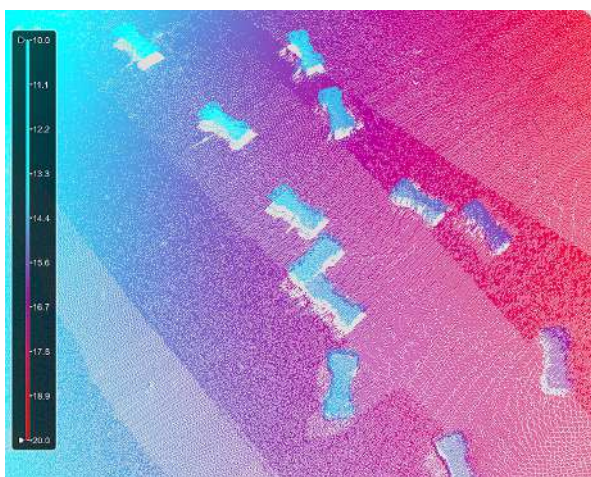
Slika 6: Sidreni blokovi prikazani u 3D oblaku točaka.
