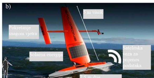
Slika 4: (a) Bespilotni helikopter (UAS) opremljen Fugro RAMMS batimetrijskim LiDAR sustavom (URL 6), (b) Saildrone autonomna brodica (URL 8)
