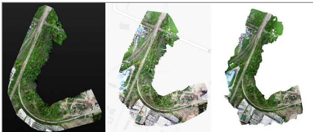
Slika 1: Dobiveni ortofoto prikazi snimanja pruge u SitScan-u (lijevo), Drone2Map-u (sredina) i Agisoftu (desno)
