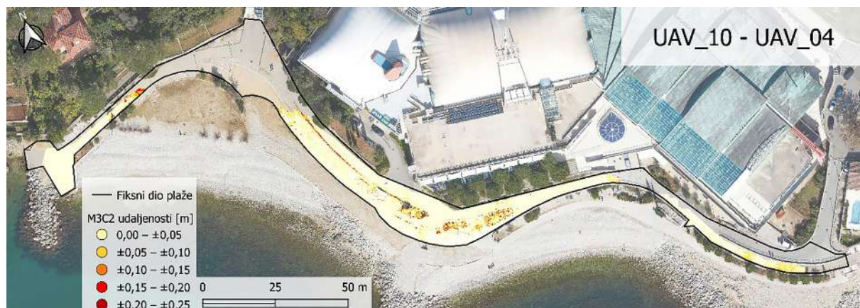
Slika 3: Usporedba iz CloudCompare-a za određivanje točnosti (izvor: Tadić i dr., 2022)
