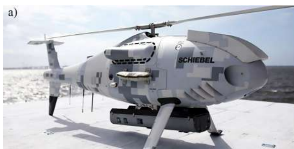
Slika 4: (a) Bespilotni helikopter (UAS) opremljen Fugro RAMMS batimetrijskim LiDAR sustavom (URL 6), (b) Saildrone autonomna brodica (URL 8)
