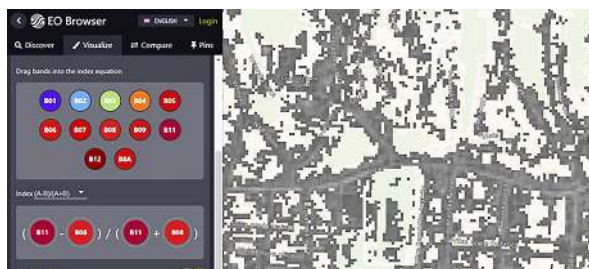
Slika 6: Kartografski prikaz satelitske snimke korištenjem NDBI metode spektralne analize i preglednika EO.
