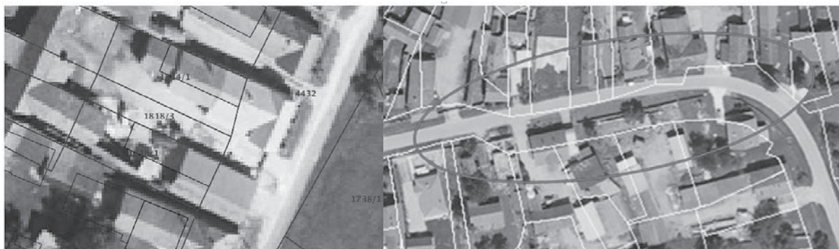
Slika 1: Nepoklapanje DKP-a s DOF-om (lijevo), anomalije nastale na spoju listova (desno)
