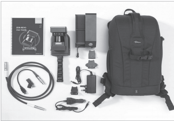
Slika 2: Komponente sustava GeoSLAM (Dutch, 2016)
