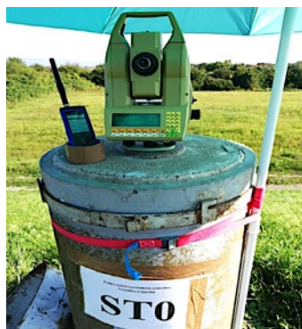
Slika 1: Precizni elektrooptički daljinomjer Leica TC2003, uređaj za mjerenje atmosferskih parametara Lufft XA1000 s temperaturnom sondom Lufft 8130.TFF i precizna prizma Leica GPH 1P
