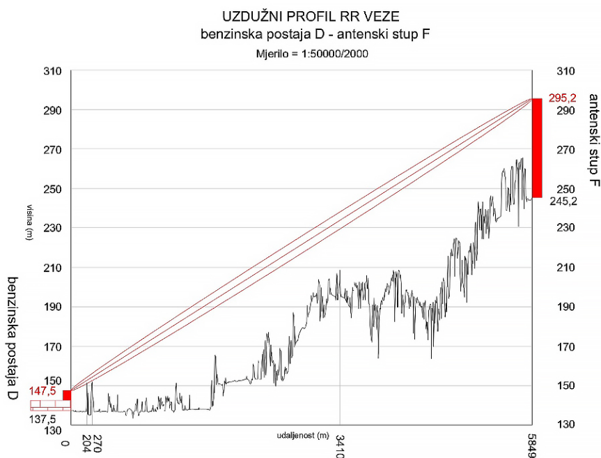
Slika 5: Uzdužni profil RR veze između planirane antene na benzinskoj postaji D i antenskom stupu F
