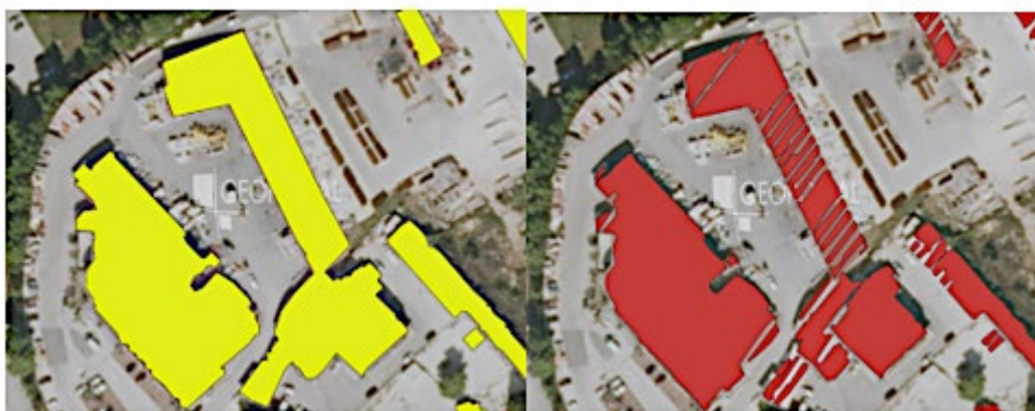
Slika 4: Razlika generiranih poligona alpha-shape algoritmom ovisno o postavci eps (lijevo eps=0,7 i desno eps=0,6)
