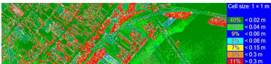
Slika 8: Rasterska karta razlika visina susjednih linija oblaka točaka na njihovom preklopnom području
