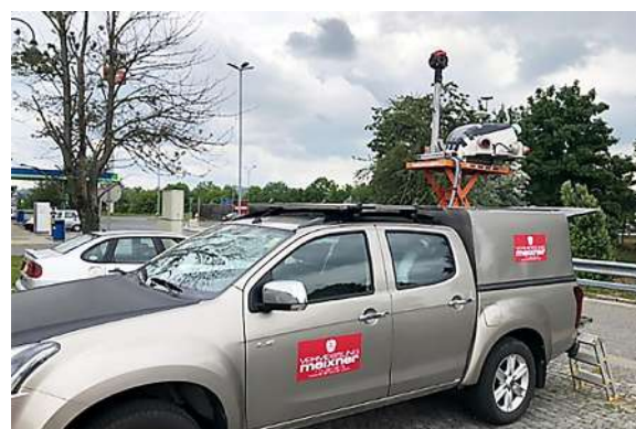
Slika 2: Primjer mobilnog sustava za izmjeru na pokretnoj platformi/vozilu, Riegl VMX-2HA, koji ostvaruje 3,6 milijuna mjerenja u sekundi uz maksimalni domet snopa od 475 metara i ostvarivu točnost od 5 mm i preciznost 3 mm te prikuplja fotografije koje pokrivaju 360° u rezoluciji do 240 MP (Izvor: arhiva tvrtke Meixner Vermessung ZT GmbH)
