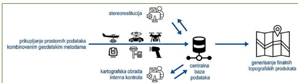
Slika 10: Proces izrade digitalnih topografskih podloga
