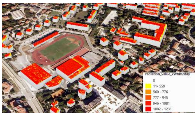
Slika 2: Količina sunčevog zračenja u kWh/m 2 na testnom području (Marković, 2023)
