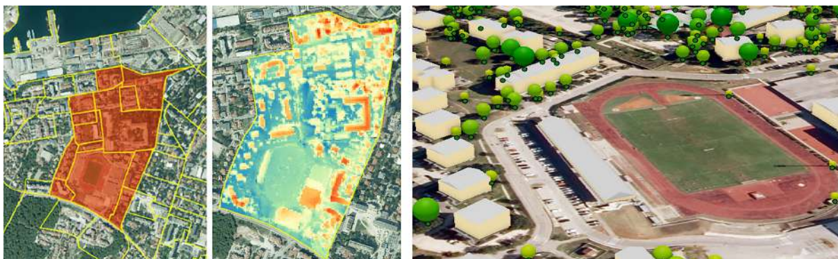
Slika 1: Prikaz testnog područja Grada Pule (lijevo), interpolirani nDSM model (sredina), 3D model testnog područja (desno) (Šain i dr. 2023)
