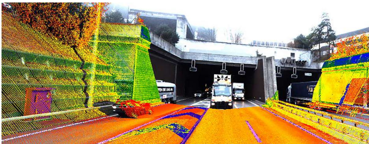
Slika 7: Mobilna izmjera austrijskih autocesta za detekciju površine cesta te prohodnosti i vegetacije koja utječe na odvijanje prometa (Izvor: arhiva tvrtke Meixner Vermessung ZT GmbH)
