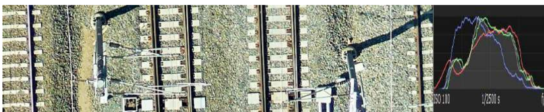
Slika 3: lijevo: Primjer dijela aerofotogrametrijskog snimka pruge Beograd – Novi Sad, desno: histogram aerofotogrametrijskog snimka
