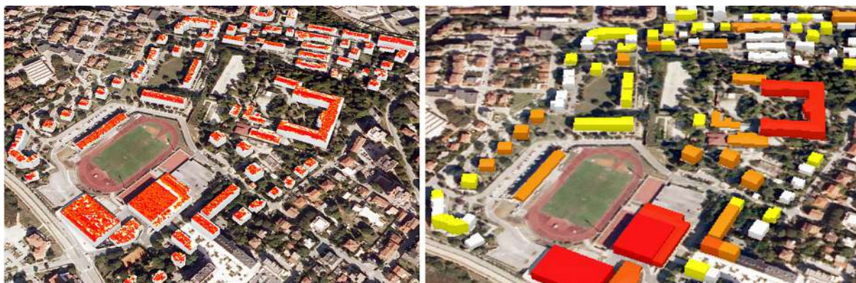
Slika 3: Pogodna područja za postavljanje ćelija (lijevo), potencijal proizvodnje električne energije (desno) (Marković, 2023)
