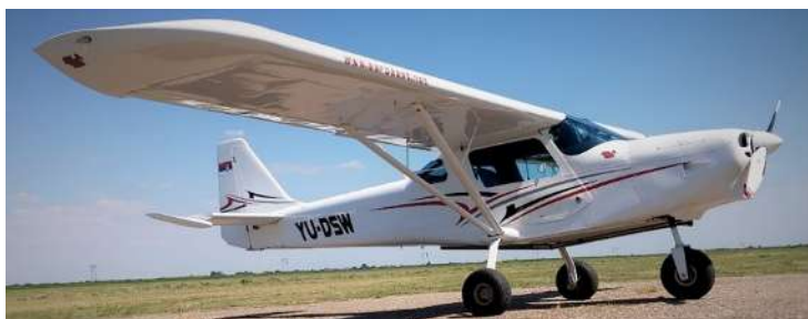
Slika 1: Zrakoplov SILA 750 – specijalno projektiran za aerofotogrametrijsko snimanje
