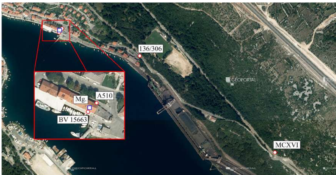
Slika 4: Položaj Mareografske postaje Bakar (Mg.), referentnih repera BV 15663 i A510 te čvornog repera MCXVI nivelmanskog vlaka br. 2 IINVT-a
