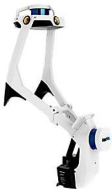
Slika 1: Primjer nosivog („ruksak“) mobilnog sustava za izmjeru, Navvis VLX 3, koji ostvaruje 1,28 milijuna mjerenja u sekundi uz maksimalni domet snopa od 300 m i ostvarivu preciznost od 5 mm te prikuplja fotografije koje pokrivaju 360° (Izvor: arhiva tvrtke Meixner Vermessung ZT GmbH)
