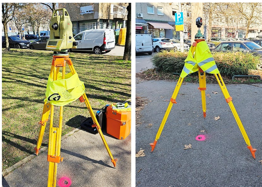
Slika 4: Postav mjerne stanice Leica TC2003 (lijevo) i reflektora Leica GPH1P (desno)
