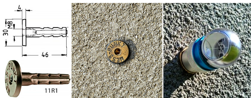
Slika 3: Prikaz ugradnje i instalacije mjerne sfere na kontrolnim točkama
